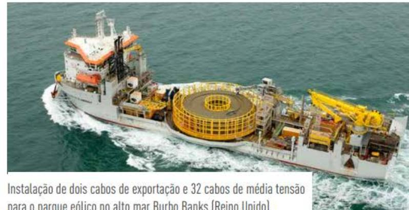
Instalação de dois cabos de exportação e 32 cabos de média tensão para o parque eólico no alto mar Burbo Banks (Reino Unido)
